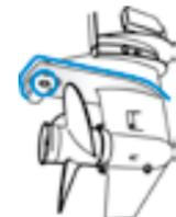
Die breite Antikavitationsplatte sorgt effektiv dafür, dass der Propeller nicht kavitiert. Die große Trimmflosse ermöglicht eine mühelose Steuerung bei hohen Geschwindigkeiten und bietet darüber hinaus einen Korrosionsschutz.
