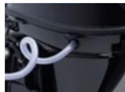
Mit einem standardmäßig eingebauten komfortablen Frischwasserspülsystem, das das routinemäßige Spülen des Motors vereinfacht.
