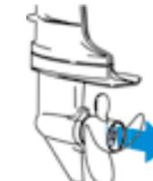
Der durch den Propeller verlaufende Auspuff sorgt für einen guten und leisen Lauf des Motors.
