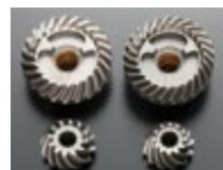
Bietet eine große Auswahl an Propellerübersetzungsverhältnissen (26:12 / 2.17), um große Propeller verwenden zu können.
