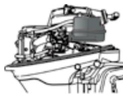
Unser Luftschalldämpfersystem besteht aus einem großvolumigen Luftschalldämpfer, der den Motorstart sicherstellt und Luftansauggeräusche während des Motorbetriebs dämpft.
